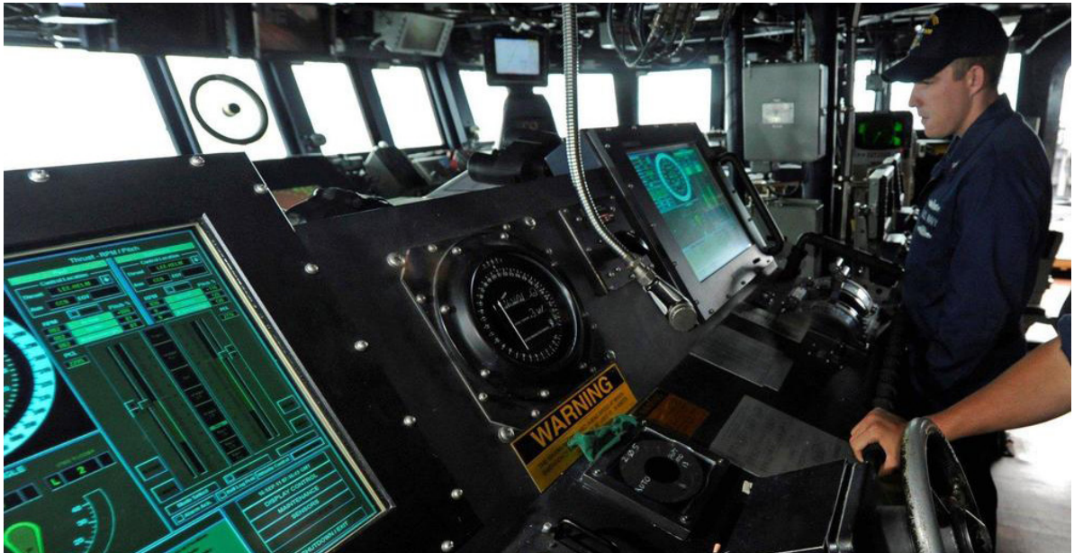
ระบบถือท้ายและสั่งจักรที่ทันสมัยบนเรือรบสหรัฐฯ คนเรือบอกว่าใช้งานยาก
