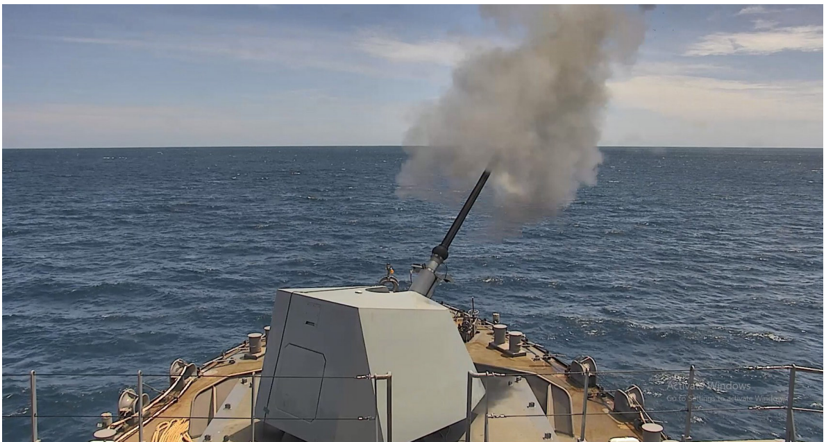
การยิงปืน ๗๖/๖๒ มิลลิเมตร Oto Melara Super Rapid Multifeed System ในการทดลองเรือในทะเล (SAT)
