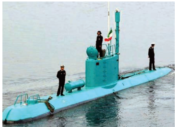
เรือดำน้ำขนาดเล็กมาก ชั้น Ghadir กองทัพเรืออิหร่าน
